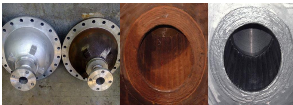
Limpeza Química Localizada
